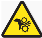
Gear Entanglement Hazard
